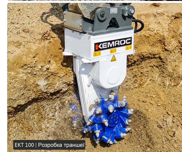
ЕКТ 100 | Розробка траншеї
